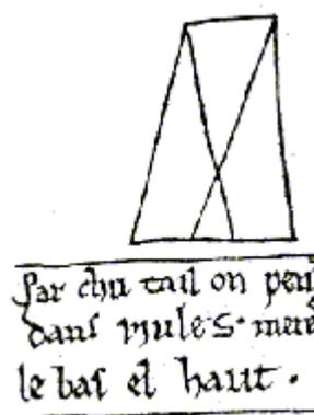
Sur un trapèze isocèle, on construit deux autres trapèzes comme sur la figure ci-dessous. Après une rotation et en utilisant les angles alternes-internes, les nouveaux trapèzes peuvent s'accoler au premier et continuer la construction de la voûte plate.
