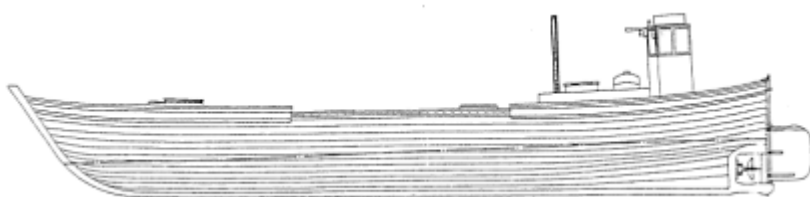
Plans au 1/20 e de la Joble , gribane du musée de la Marine de Caudebec en Caux
